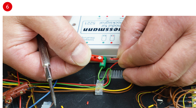
Farbenlehre: Das Lichtsignal wird an die Buchsen am Steuermodul angeschlossen, die Farben entsprechen der roten und grünen LED des Signals.
