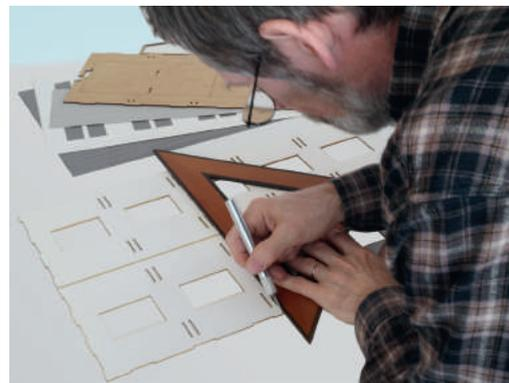
... legt man zum Kürzen des Bausatzes ein langes Lineal an und zieht entweder eine dünne Linie oder schneidet die Seitenteile gleich direkt mit einer Ziehklinge ab.
