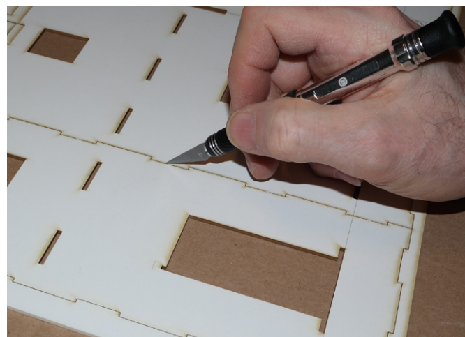
Alle Teile des Bausatzes sind per Laser vorgeschritten – bis auf ein paar Fixierstege, die man mittels Ziehklänge leicht durchschneiden kann.
