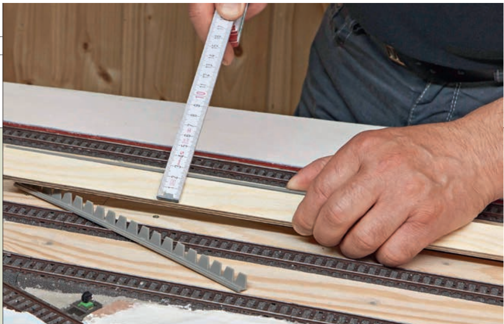
Unser Selbstbaubahnsteig hat einen Kern aus 6 mm starkem Sperrholz in 26 mm Breite gesägt.
