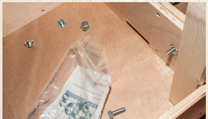
Mithilfe der abgebildeten Einschlagmuttern und M8-Maschinenschrauben wird eine stabile Verbindung zwischen zwei Elementen hergestellt.
