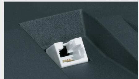
Die s88-Anschlussbuchse auf der Unterseite der Central Station 3+ (Art. 60216).
