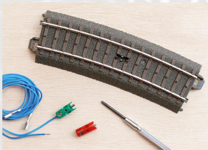
Die kleine Wippe in der Mitte des Schaltgleises wird vom Schleifer eines Fahrzeugs geschaltet – beide Fahrrichtungen sind möglich.
