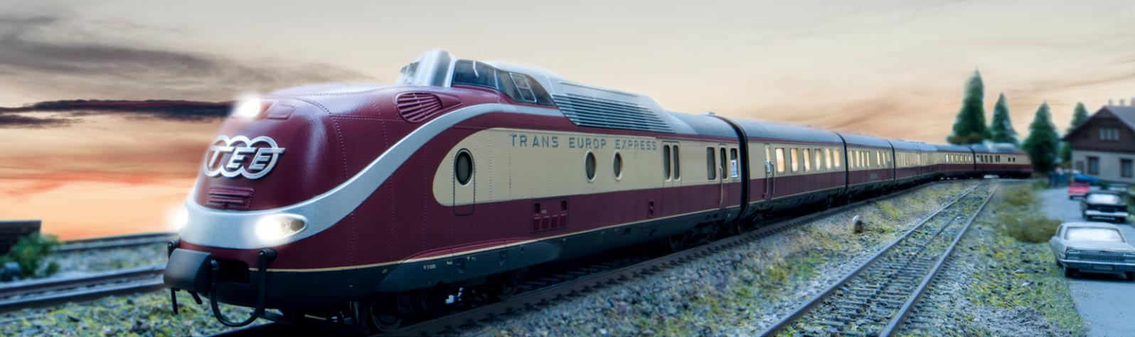
In einem Modell wie dem VT 11.5 (Bild oben) oder einem ICE sind in beiden Triebköpfen Schleifer verbaut. Die Schleiferumschaltung sorgt dafür, dass nur der in Fahrtrichtung vordere Schleifer leitend mit dem Gleiskörper verbunden ist. Sind für den Übergangsbereich die üblichen Längen von 70 bis 90 Millimeter eingehalten, gibt es auch bei Modellen mit zwei Schleifern keine Probleme mit dem „Halt“ vor dem Signal.
